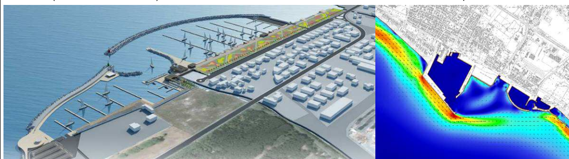
Simulazioni numeriche dell'evoluzione della foce nell'ambito del "Monitoraggio dell'intervento di riqualificazione funzionale del tratto costiero in corrispondenza della foce del Bevano". Ravenna, 2010.
