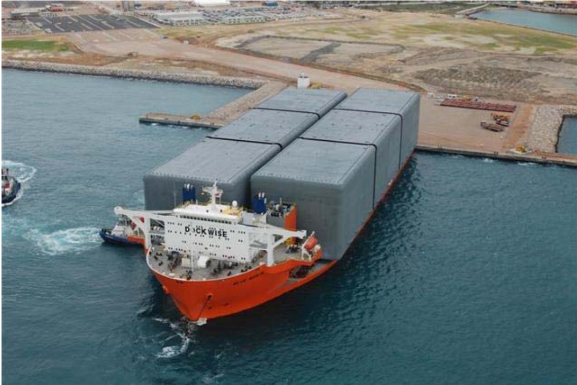
Impianto di rigassificazione dell'Alto Adriatico - Dicembre 2006 - I serbatoi di stoccaggio, realizzati in Corea del Sud, giungono ad Algeiras per essere installati nel GBS
