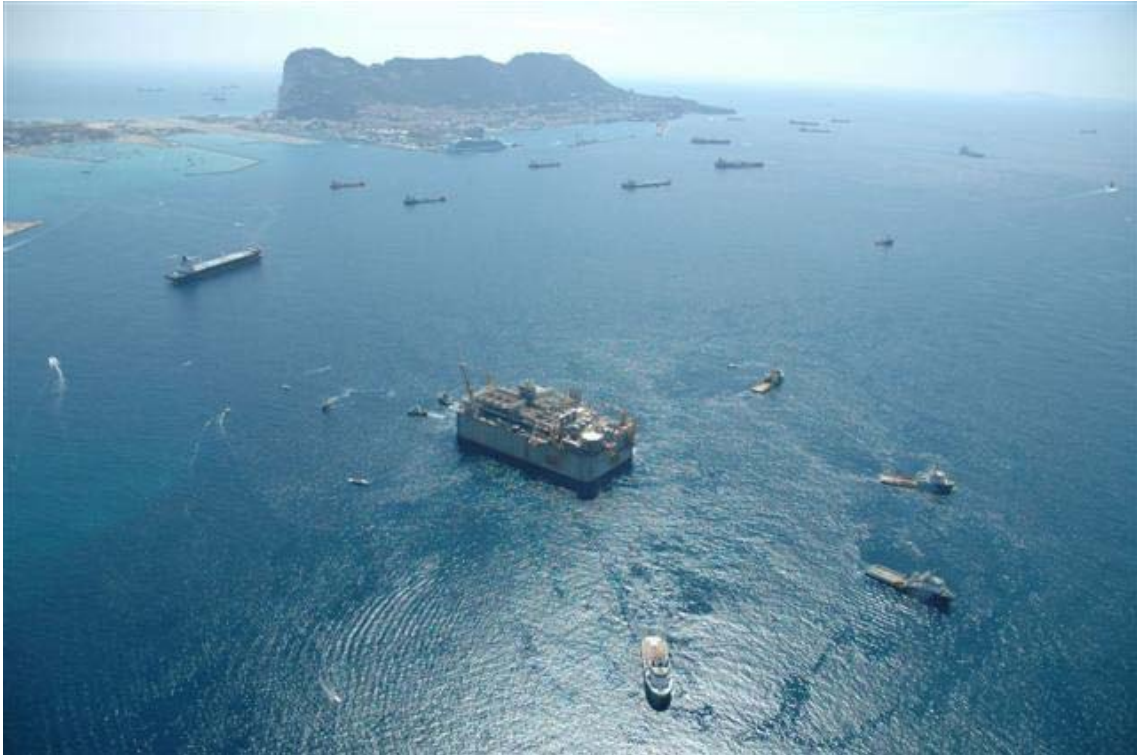
Impianto di rigassificazione dell'Alto Adriatico - Il GBS parte da Algeciras, trainato da quattro grandi rimorchiatori oceanici fino alla propria destinazione finale al largo della costa veneta
